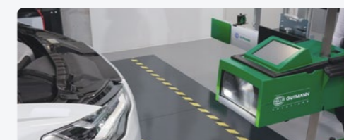
Finaler Akt in der Werkstatt: Funktionskontrolle und korrekt einstellen.
